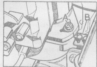
Fig. 89 - Referencias en la bomba de inyección para puesta a punto
