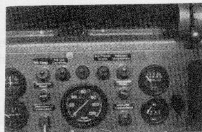
Fig. 38 - Manómetro de aceite
